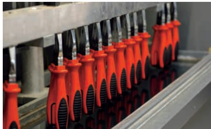
Testy pod napięciem 10.000V
