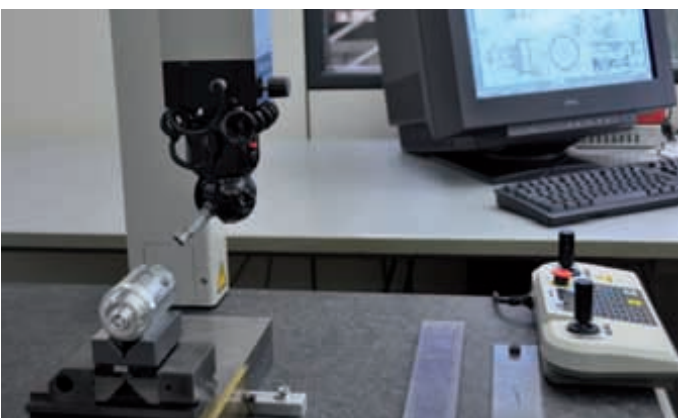
Kontrola rdzenia pompy hydraulicznej przez narzędzie 3D
