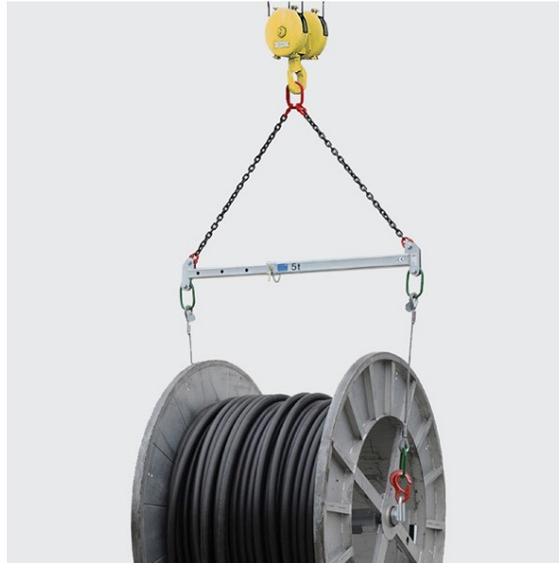
Ladetraversen für das sichere Heben und Transportieren von Kabeltrommeln. Mit einer Kettenaufhängung und 2 Seilgehängen passend für Trommeln siehe Tabelle unten. Andere Abmessungen sind kurzfristig lieferbar.
