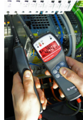
Dodatkowe obciążenie - test różnicowoprądowy. Przyciski RCD
