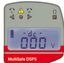
Zmiana koloru podświetlenia LCD w czasie pomiaru napięcia
